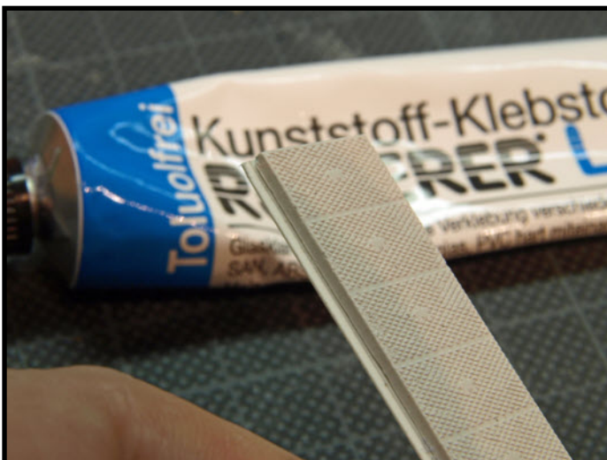
Als Erstes wird der Flansch für die Spurrillen aus Kunststoff unter die Mittelplatten aus Spezialgips geklebt.
