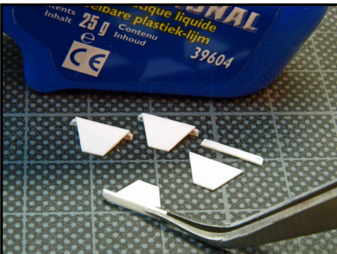
Danach werden die Kupplungsabweiser montiert. Dazu werden die Trägerstreifen mit flüssigem Plastikleber auf die eigentlichen „Bleche“ aufgeklebt.
